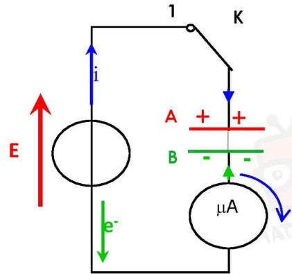
Lorsqu'on ferme (K) sur la position 1, il y a déplacement d'ensemble d'électrons dans les fils conducteurs du pôle N(-) vers l'armature B et de l'armature A vers le pôle P(+) du générateur. Les électrons s'accumulent sur B qui se charge négativement et par influence l'armature A se charge positivement. Un courant électrique circule de P vers A et de B vers N jusqu'à ce qu'il apparaisse une charge (+q) sur A et une charge (-q) sur B créant une d.d.p :  $v_A - v_B = u_{AB} = E$
